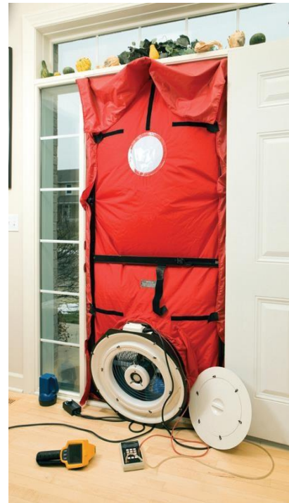
Blower Door Test
